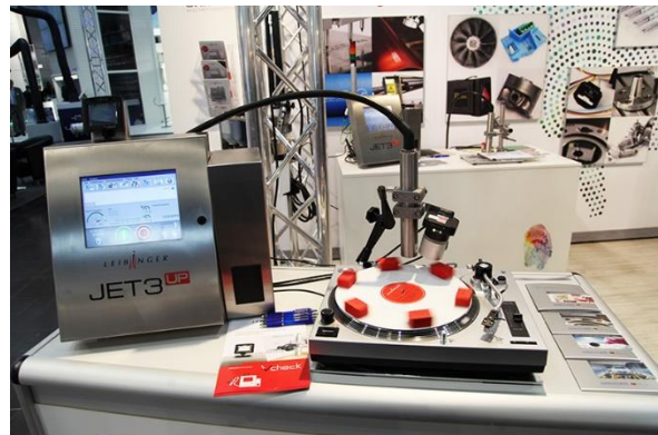
Kennzeichnungsanlage mit Leibinger Jet 3up und Vcheck
